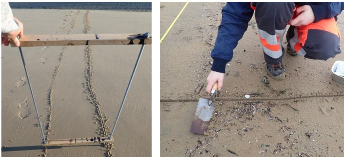
Figure 3 : (a) Traçage d'une bande de 50 cm de large. (b) Prélèvement de microplastiques échoués (source : Cedre).
