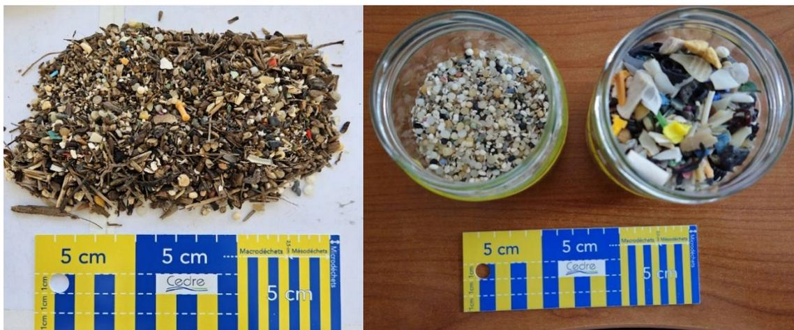
Figure 4 : (a) Échantillon contenant de la matière organique avant tri. (b) Echantillon nettoyé : les grands microplastiques (à gauche) et mésoplastiques (à droite) (source : Cedre).
