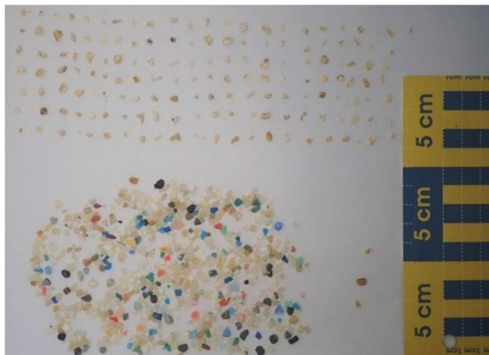
Figure 5 : (a) Catégorisation et comptage en laboratoire des grands microplastiques. (b) Pesées des différentes catégories de microplastiques (source : Cedre).
