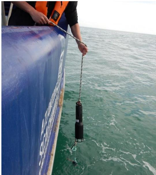
Figure 11. Mesure du profil hydrologique dans la colonne d'eau à l'aide d'une sonde WiMo
