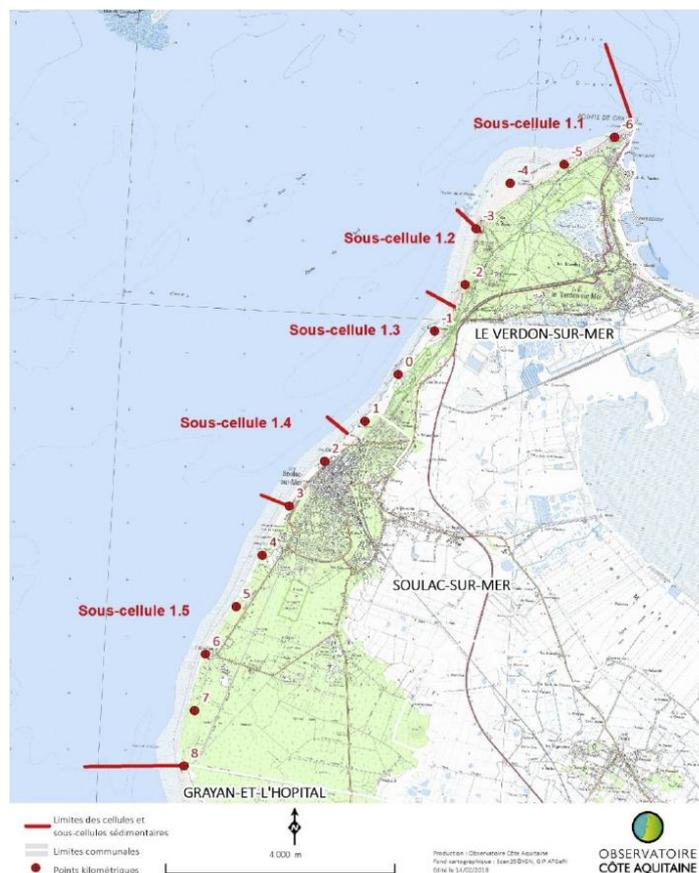
Figure 6-4 : Découpage du « Nord Médoc » en 1 cellule hydro-sédimentaire et 5 sous-cellules homogènes, interdépendantes (1.1 à 1.5) par de l'OCA, 2018 (actuel OCNA).
