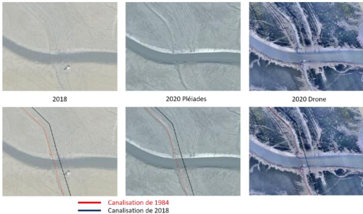
FIGURE 53. EMPLACEMENT DES CANALISATIONS DE 1984 ET 2018 SUR L'IMAGE DE 2018, LA PLEIADES DE 2020 ET L'ACQUISITION DRONE DE 2020.
