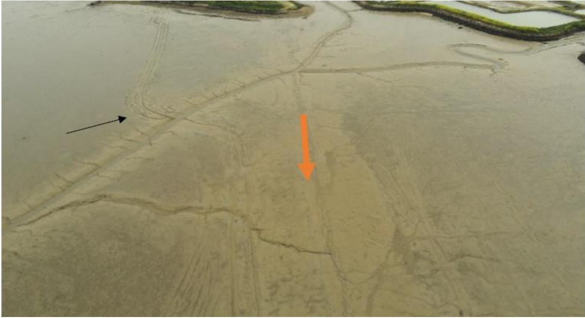
FIGURE 4 : IMAGE DRONE D'AVRIL 2019 (G. GARBAYE). FLECHE NOIRE : TRACE DE LA PELLE AMPHIBIE. FLECHE ORANGE : TRACE DES CONDUITES
